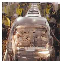
溶接スパッタ/ レーザー
